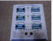
○車型LED・電球比較実験ツール 手回し発電機で電球点灯。LEDと電球の必要電力を手回 しの重さで比較できます。
