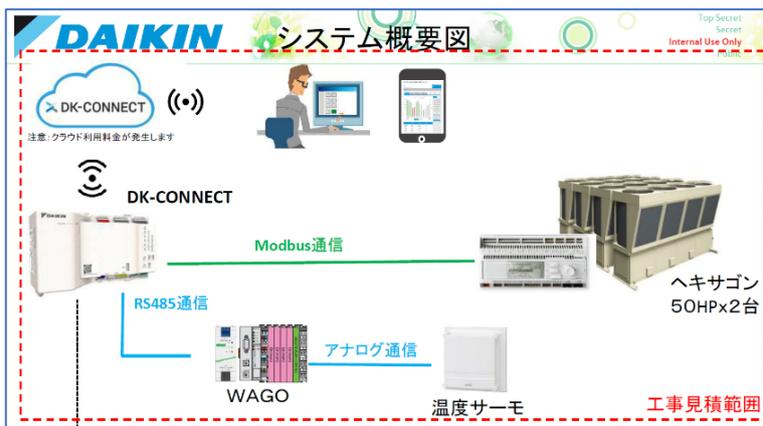
第2工場に導入したIoT活用空調システムの概要図
